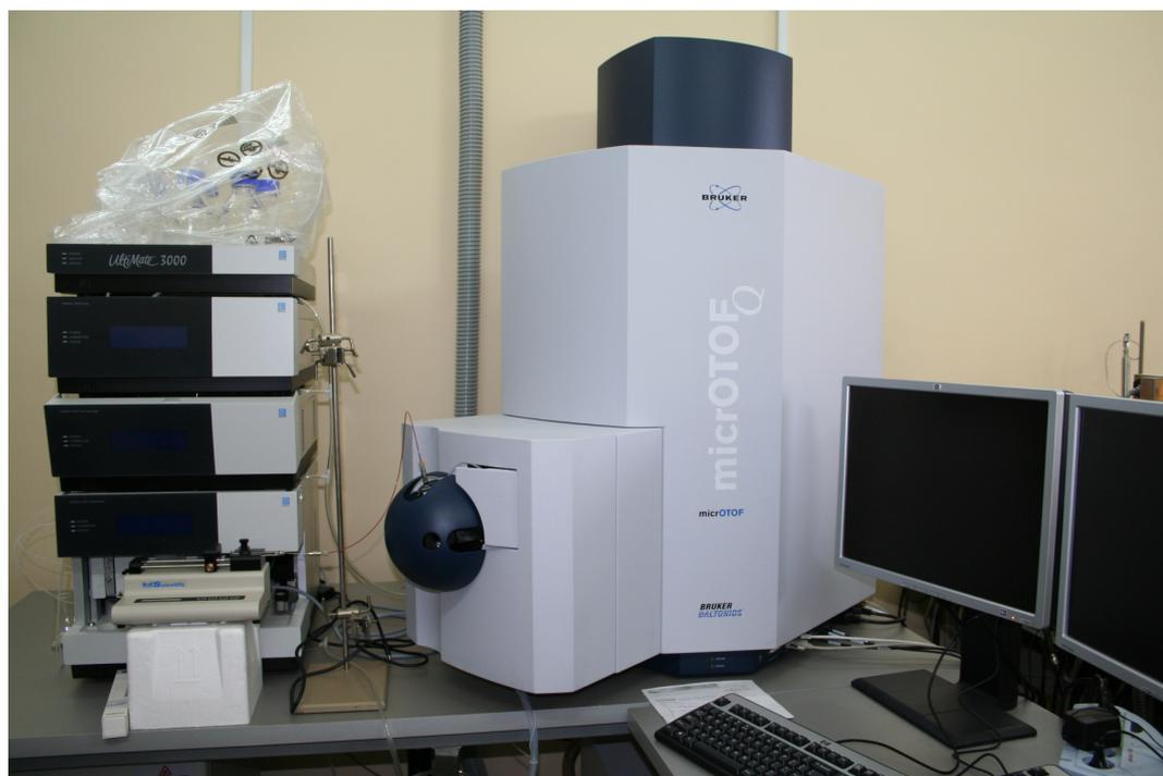
**МС/МС производительность** Сочетая уникальные особенности времяпролетного масс-спектрометра microTOF - отличную точность определения массы и превосходную разрешающую способность, превышающую 17,5000 - с возможностью получения МС/МС данных, microTOF-Q II позволяет проводить de novo секвенирование пептидов и даже определение пост-трансляционных модификаций. Надежность результатов протеомных исследований гарантируется точностью определения молекулярных масс и структурным анализом малых молекул.
