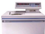
Ультрацентрифуга OPTIMA MAX - напольная и настольная лабораторная центрифуга. В основном ультрацентрифуги применяются для разделения и выделения белков, липопротеинов, плазмид ДНК, РНК, субклеточных органел и вирусов.
